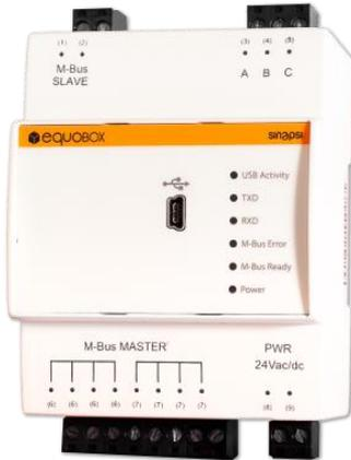
Il level converter M-Bus della famiglia EQUOBOX SIN.EQLC1 consente l'interfacciamento ad una rete di dispositivi conformi allo standard M-Bus (EN13757-2 Physical Layer) e supporta fino a 60 slaves.
